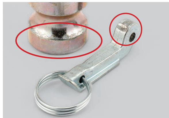
Abnutzungspuren am Stecker und Hebel
