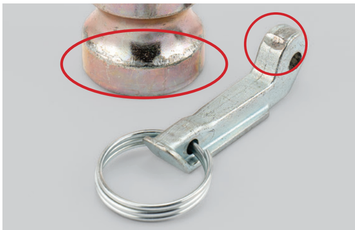
Marcas de tensión en el enchufe y en la palanca
