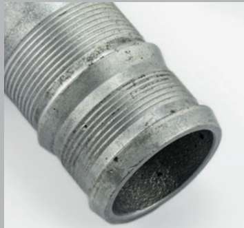
Lunker in der Schlauchtülle
